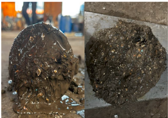
6 mm-coir fiber and vermiculite (d) 6 mm core section
